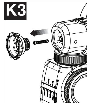
• Dévisser la cartouche du pulvérisateur en tournant la bague comme le montre la **figure K4**. Déposer le tube d'aspiration, le filtre et le joint torique du pulvérisateur. Nettoyer les pièces avec la brosse de nettoyage et la bonne solution de nettoyage.
